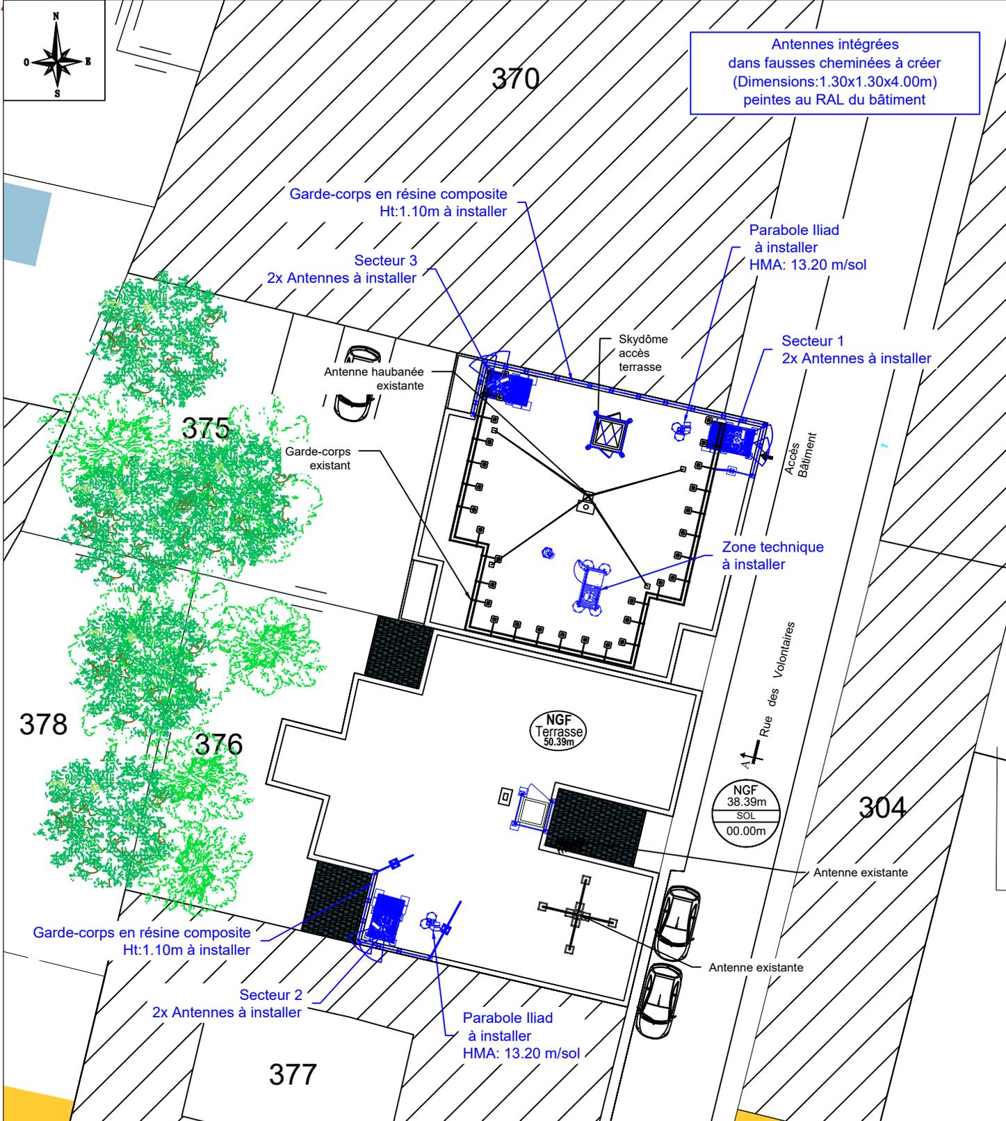
Antennes intégrées dans fausses cheminées à créer (Dimensions:1.30x1.30x4.00m) peintes au RAL du bâtiment
