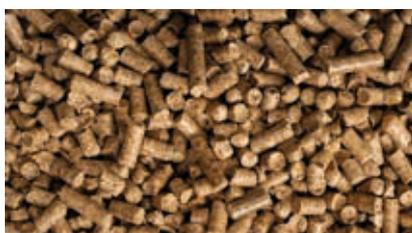
le granulé de bois est un combustible produit à partir des sciures, copeaux ou chutes de bois de feuillus et résineux, de 3 à 5 cm de longueur et de 6 à 8 mm de diamètre. Ces produits résiduels sont séchés, broyés puis comprimé à très haute pression sans aucun additif. Il est utilisé dans des poêles ou des chaudières spécifiques, pour le chauffage du particulier ou dans des installations collectives.
