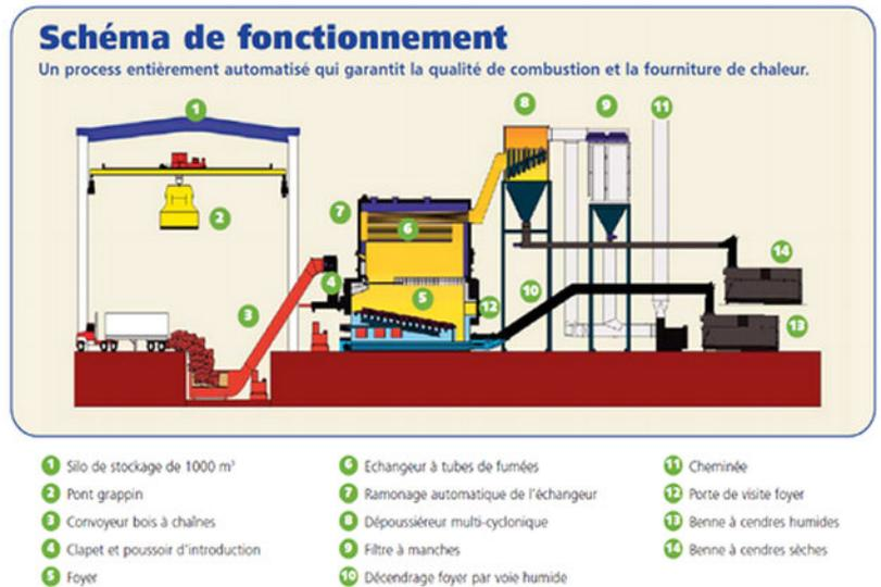
La combustion de cette énergie propre se fait dans les meilleures conditions grâce à des chaudières de haute performance équipées d'une double filtration des fumées. Une gestion automatisée des installations techniques permet d'en assurer le bon fonctionnement.
