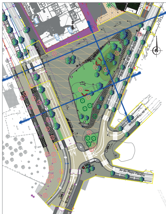
PLAN CAMPUS : PINS CONSERVÉS DANS LE CADRE DE L'AMÉNAGEMENT DU PARVIS DES BÂTIMENTS UNIVERSITAIRES (SOURCE : TAM - MONTPELLIER3M)
